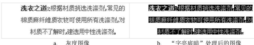
图 27 “字亮底暗”处理前后的字符图像
